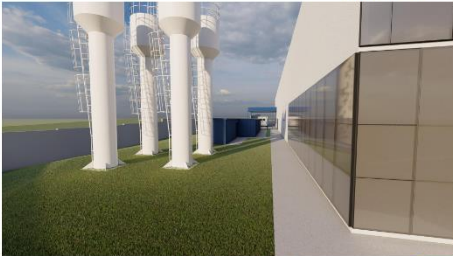
Caixas d'água e abrigo de gases medicinais
